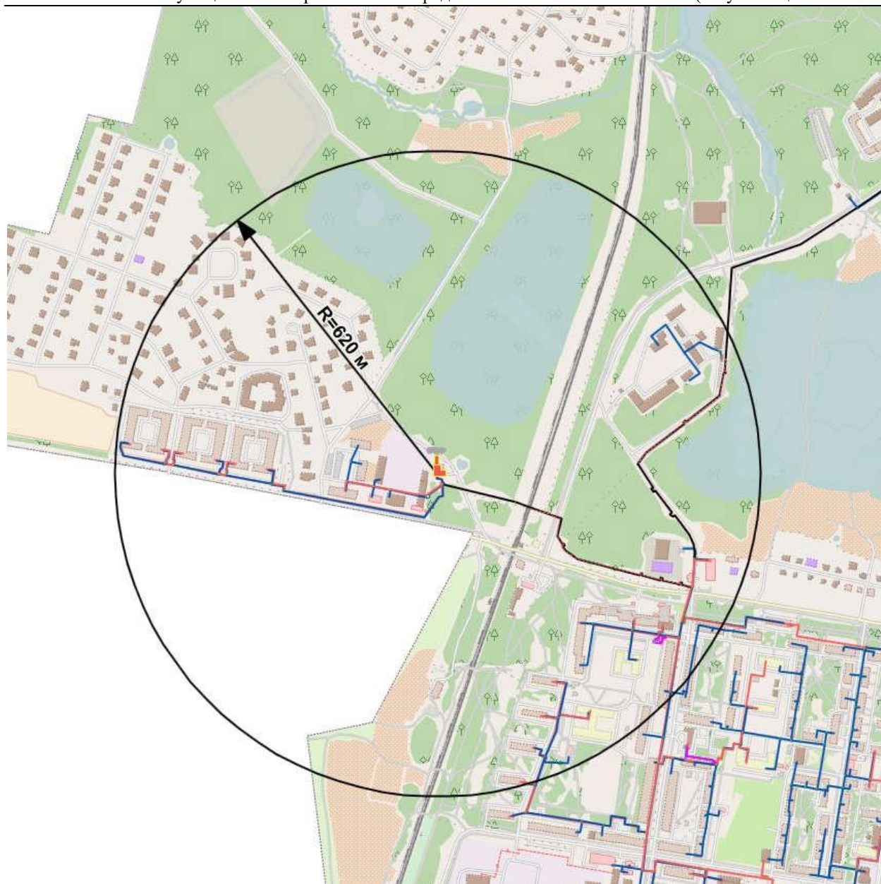
Рисунок 41 Радиус эффективного теплоснабжения БМК 1
